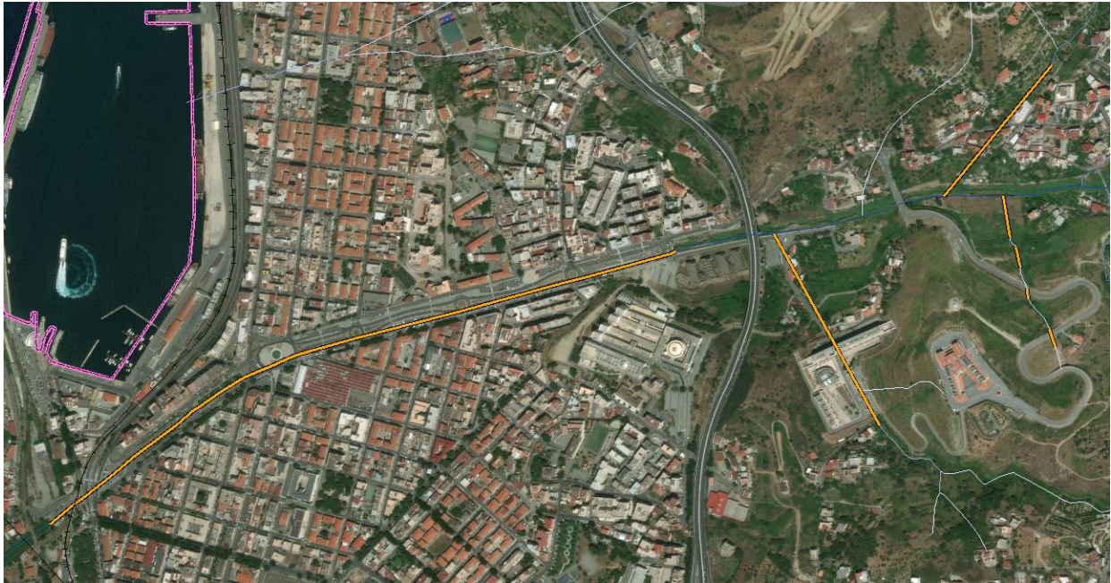
Fig. 3 – Individuazione dei tratti tombati per la città di Reggio Calabria (tratti di colore arancio). Particolare dell’asta terminale della fiumara Annunziata.
