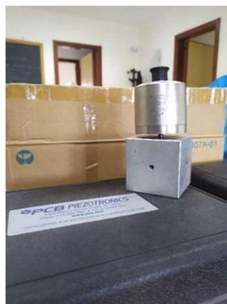
*Figura 2-7 - Stazione accelerometrica usata per i test*
