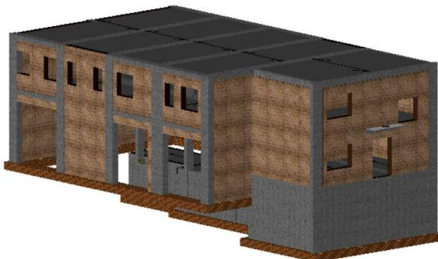
*Figura 2-40 MODELLO A ES3 Castellaneta - Modello 3DMacro - Vista assometrica modello geometrico con interazione tamponature*
