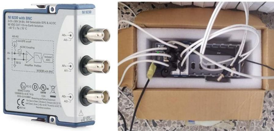
Figura 2-8 Centralina di acquisizione e chassis di alloggiamento a 8 slot
