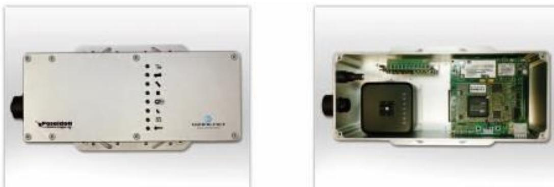
Figura 2-6 Stazione accelerometrica TIPO utilizzata per i test
