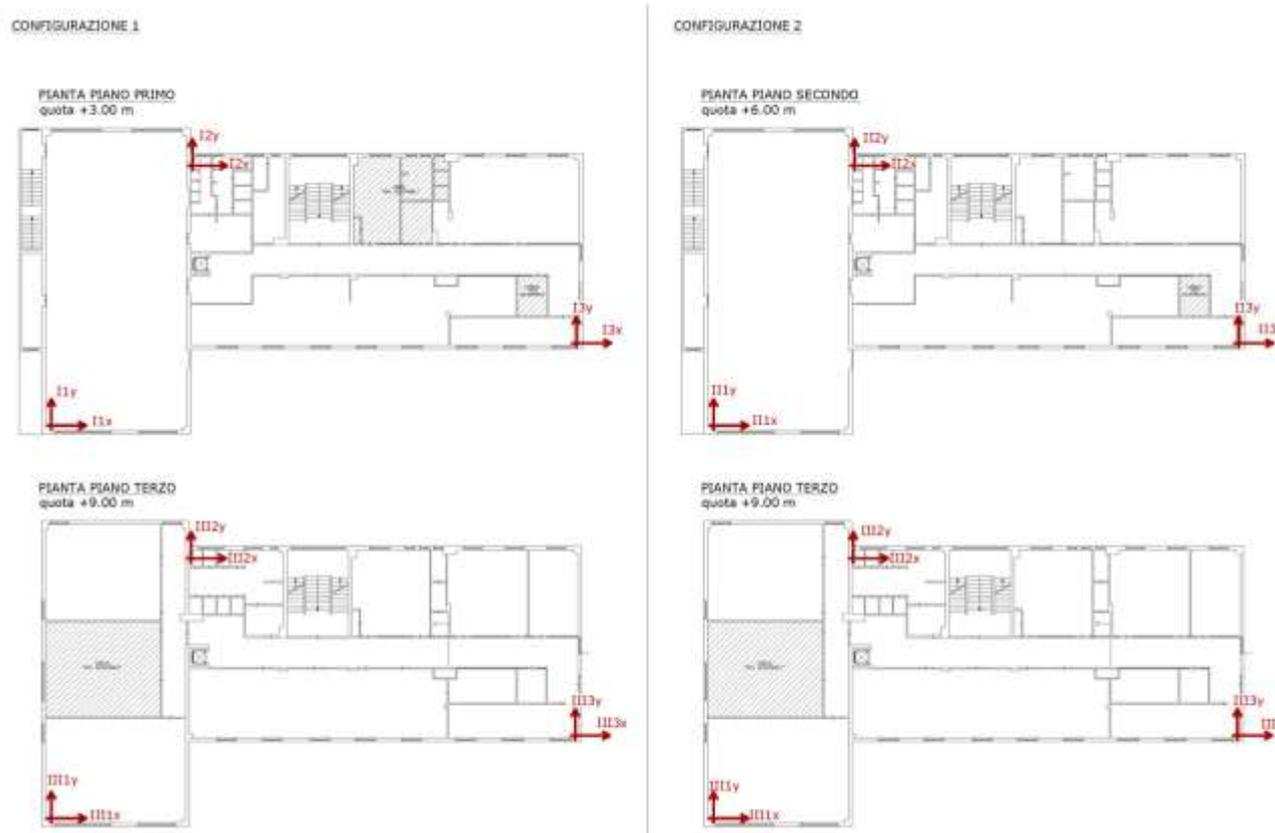
Figura 8 - Schema di possibili soluzioni per la distribuzione planimetrica dei punti di misura.
