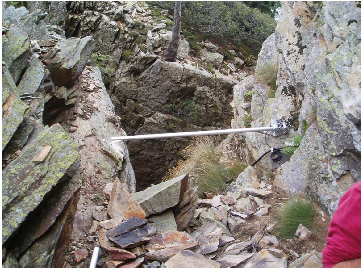
> Figura 2.2.2 Estensimetro monoassiale a barra (Fonte: foto Gregorio Mannucci).
