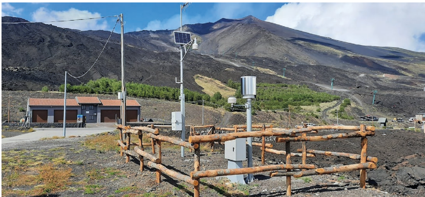
> Figura 2.2.3 Stazione pluviometrica, nivometrica e termo-igrometrica (Fonte: foto Rete Meteo Regione Siciliana).
